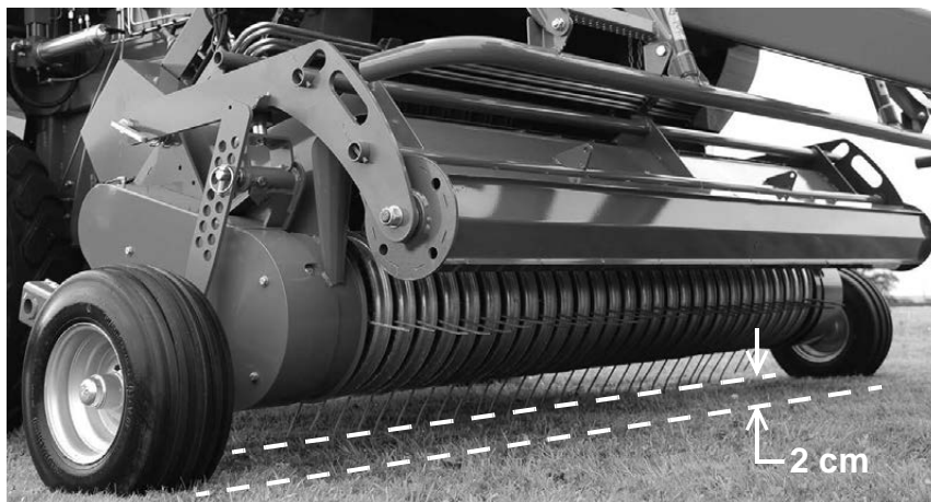
Mynd 10.b - Stilling sópvindunnar
