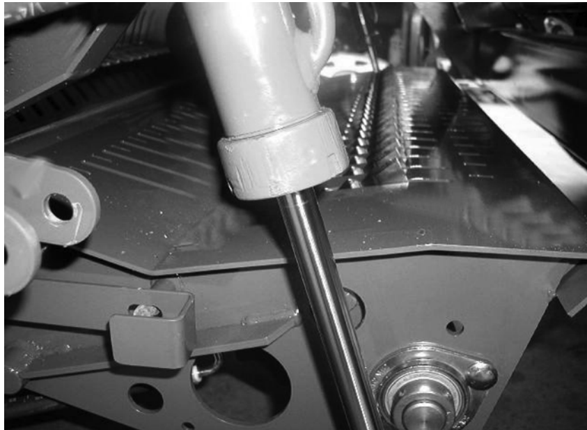
Mynd 10.g - Stíflulosun í gangi, hnífar dregnir til baka og botn mótunarstokks niðri
