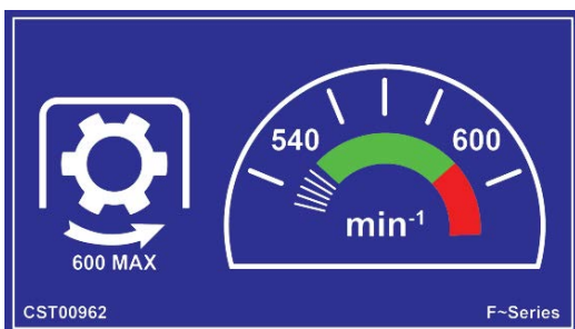
Stilling girkassa sem merktur er fyrir 540 sn./mín.
