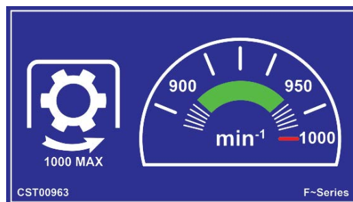
Stilling girkassa sem merktur er fyrir 1.000 sn./mín.
